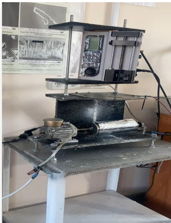
11 сурет – Электроспиннинг әдісіне негізделген құрылғы
